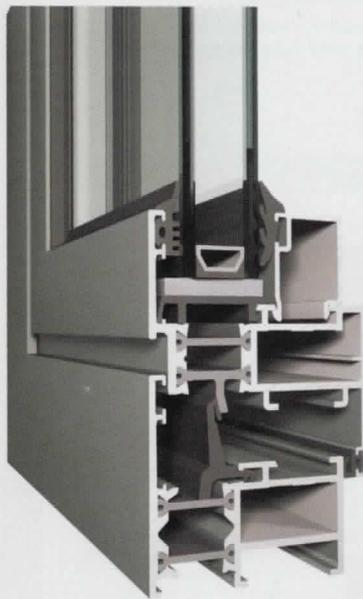
Le système thermique isolant TS 57 pour fenêtres et portes-fenêtres offre une liberté de formes et de couleurs qui en fait la réponse idéale aux souhaits des architectes et des maîtres d'ouvrage par sa liberté de forme : Droite (Fonctionnel) ou Arrondie (Softline). Une solution universelle à rupture de pont thermique avec dormant base 50 mm. La référence de la fenêtre traditionnelle.
