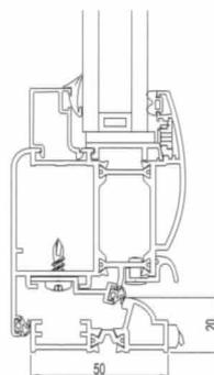
Seuil de 20 mm en conformité avec le DTU 36.5 et les directives du CSTB
